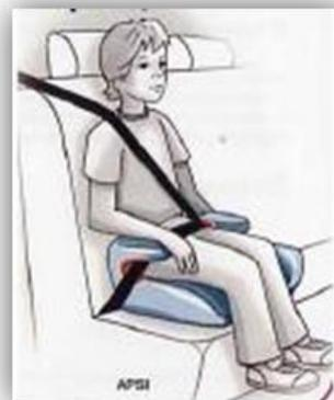
**Figura 3** – Bancos elevatórios (Grupo III) (Adaptado de APSI, 2007)<sup>15</sup>
