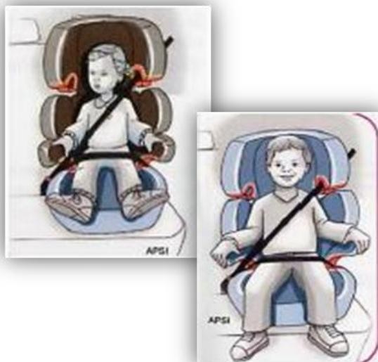
**Figura 2** – Sistemas de Retenção do Grupo II e do Grupo III (Adaptado de APSI, 2007)<sup>15</sup>
